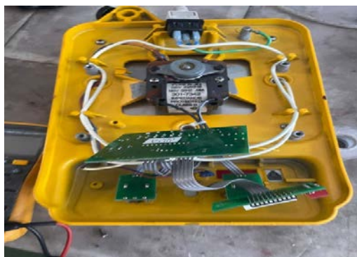
Revisión y reparación de la tarjeta de una parrilla de calentamiento y agitación
