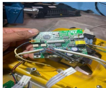
Revisión y reparación de la tarjeta de una parrilla de calentamiento y agitación
